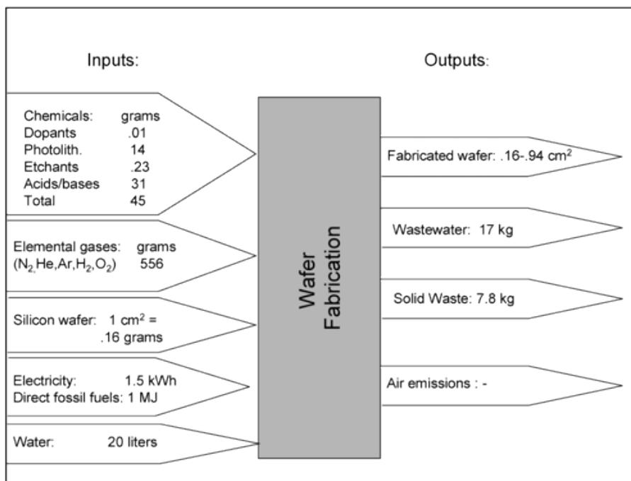
*Ilustración 2: Material y energías necesarios para fabricar 1 cm<sup>2</sup> (0'16 gramos) de microcircuitos sobre una oblea de silicio. Sería el equivalente, por ejemplo, de un chip de memoria DRAM de 20 Mbytes [ERI3].*
